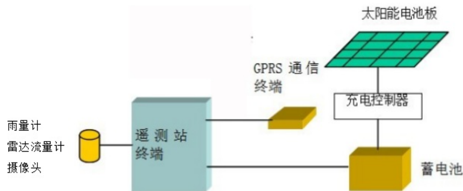
图1 一体化雨量遥测站系统集成示意图
